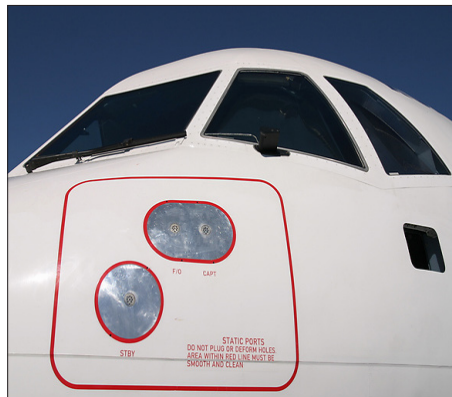
شکل ۴: محل قرارگیری ورودی های پیتوت-استاتیک بر روی بدنه هواپیما
